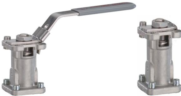
Schaltwellenverlängerung Typ 1621D aus gegossenem Edelstahl - Gehäuse mit innenliegender separat gelagerter Schaltwelle. Ausgestattet mit ISO-Top-Flansch nach EN ISO 5211 für eine Antriebsmontage. Mit vorbereitetem Leckage - Messpunkt im Gehäuse. Handhebel mit abschliessbarer Arretiervorrichtung.
